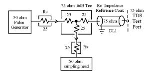
Fig. 8 75  $\Omega$  TDR using a 75  $\Omega$  , 6 dB Tee
